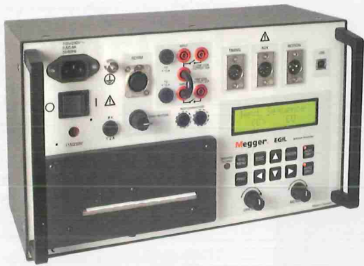
Bild 2. Egil-Schalteranalysator von Megger
