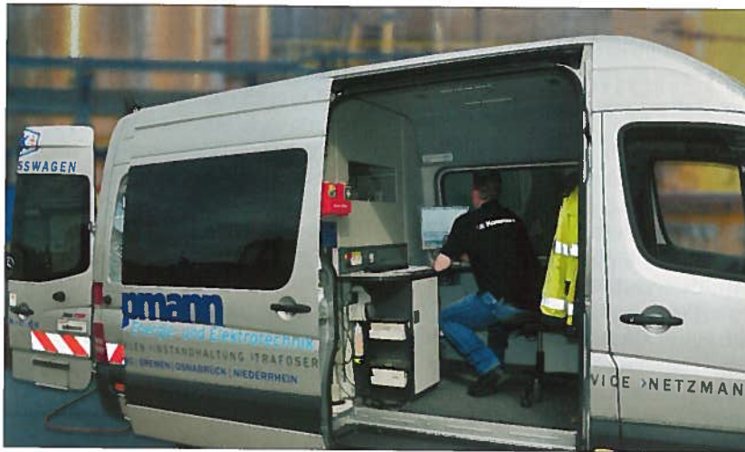
Bil 3: Die zentrale Steuerung des Centrix ermöglicht eine schnelle Abfolge aller notwendigen Prüfungen
